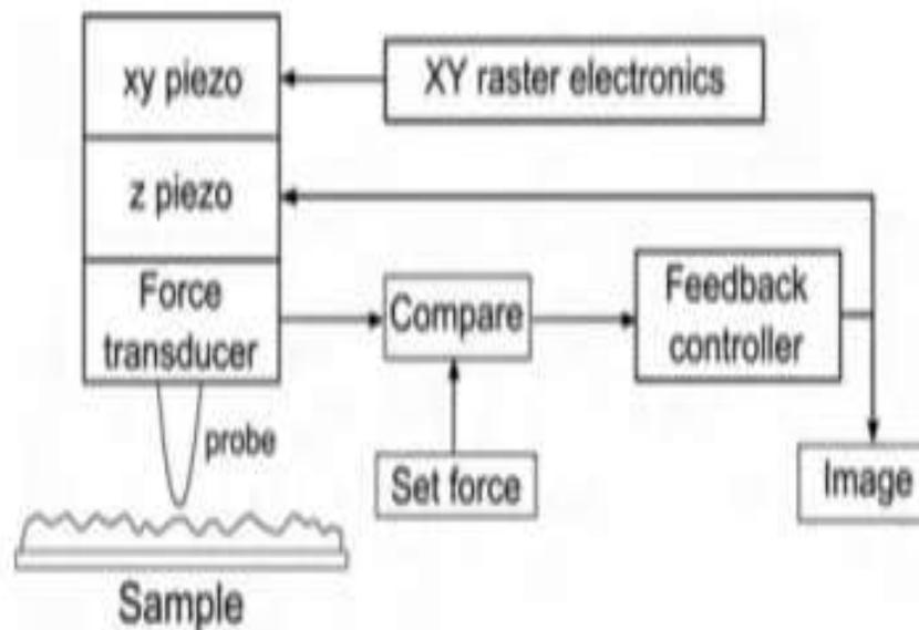
**FIGURE 1: BLOCK DIAGRAM OF AFM OPERATION [21]**
